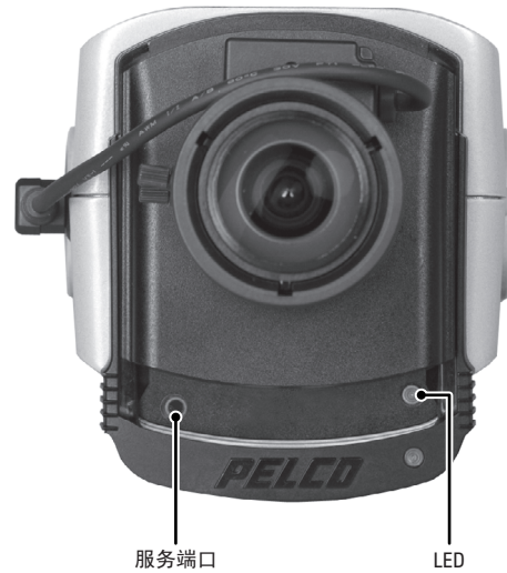
前视图, 仅摄像机 (打开以显露服务端口)
