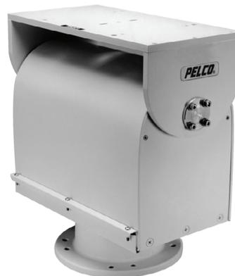
**PT1250P** 是重型云台，负重可高达 100 磅 (45.4kg)。该云台装有带有可调蜗轮传动驱动装置的高扭矩 AC 电机，可保证较长的工作寿命和无偏差的运转。
